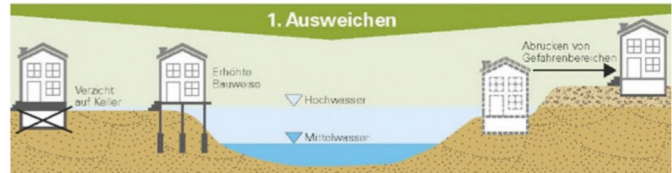
Abb. 1: Ausweichen als effektivste Strategie der Hochwasservorsorge; hochwasserempfindliche Nutzungen werden aus den Gefahrengebieten herausgehalten oder in einer Höhe über dem maximalen Hochwasserstand angeordnet. Quelle: LfU.
