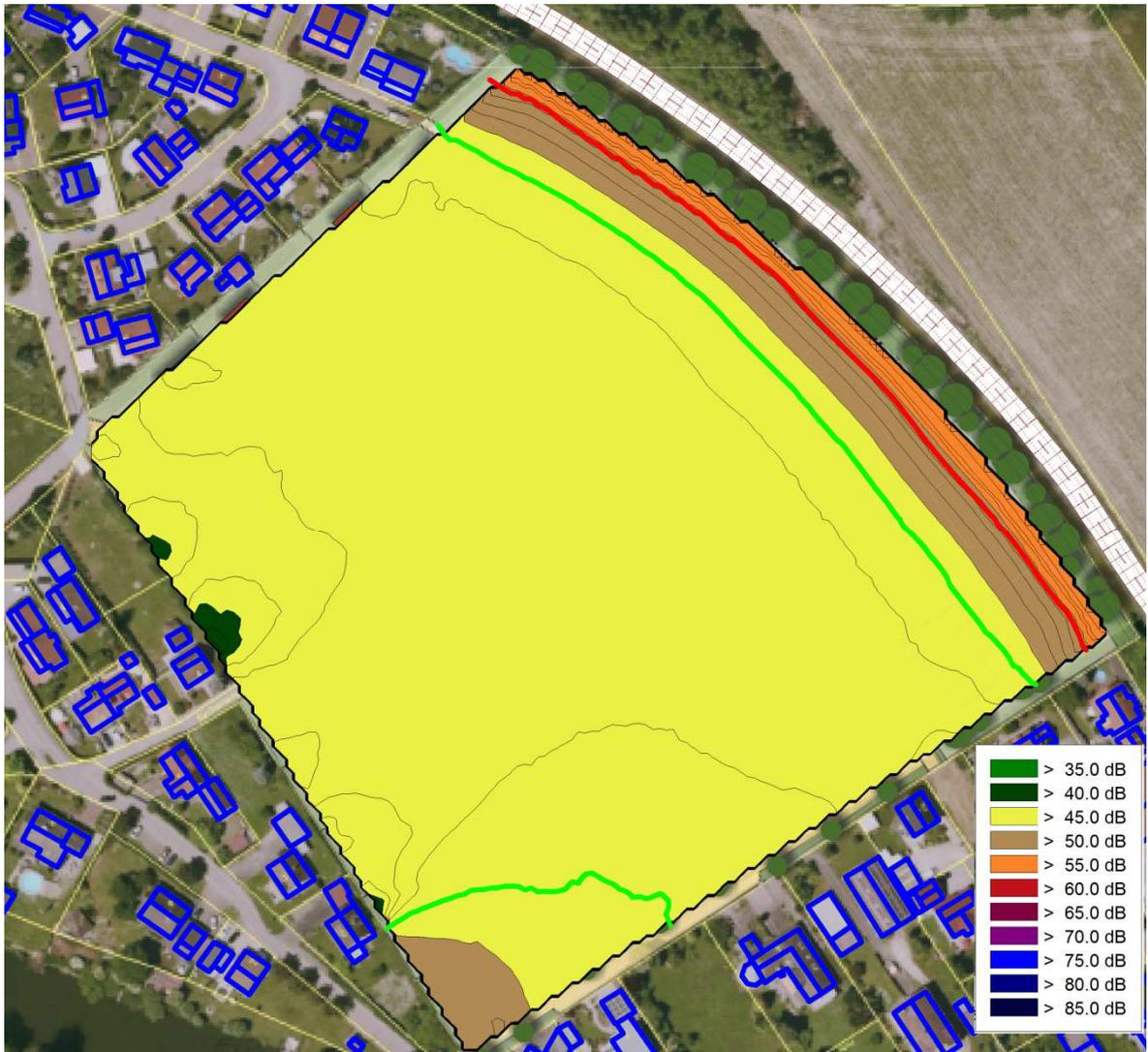
Abb. 8: Rasterlärmmkarte nachts in 5,30 m Höhe (1.OG), rot markiert die 54 dB(A) Isophone, grün markiert die 49 dB(A) Isophone
